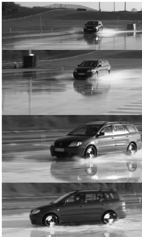
Fot. 5. Zablokowane koła samochodu – hamowanie bez ABS
