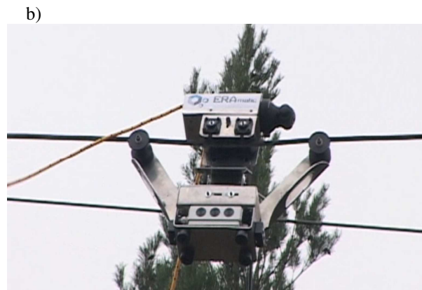
Rys. 2. Robot mobilny: a) model fizyczny robota – widok z przodu; b) rzeczywista maszyna zawieszona na przewodzie linii podczas prób weryfikacyjnych [1]
