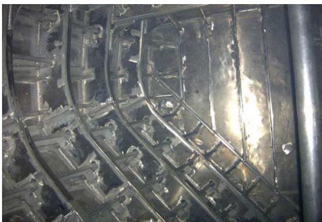
Rys. 1. Spawana konstrukcja okrętu ze stopów aluminium
