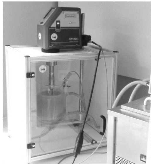
Fig. 6. Cavitation test stand
