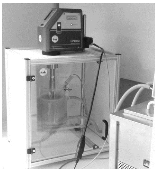
Fig. 6. Cavitation test stand
