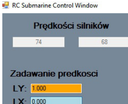
Rys. 11. Odbiór danych z mikrokontrolera (na szarym tle) i wysyłanie wartości zadanej (pomarańczowe tło)
