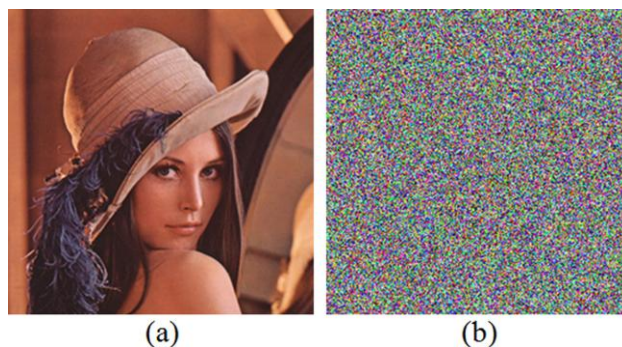
Rys. 26. Deszyfracja błędnym kluczem przeprowadzona dla algorytmu S-QFC: (a) obraz oryginalny, (b) obraz odszyfrowany przy zastosowaniu innego klucza rundowego (różnica na 1 bicie względem klucza oryginalnego).
