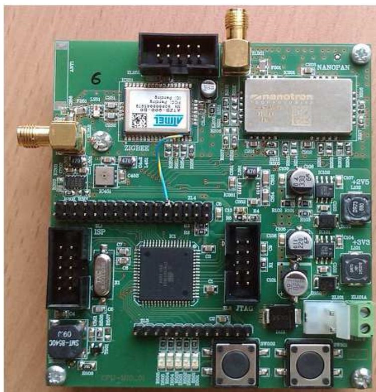
Rys. 4.3. Prototypowa wersja modułu identyfikacji osobistej MIO
