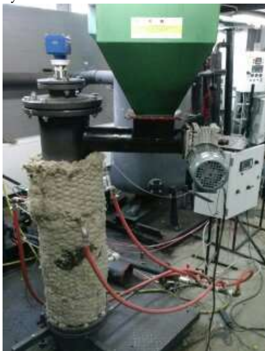
Rys. 2. Reaktor do zgazowania INKA.
