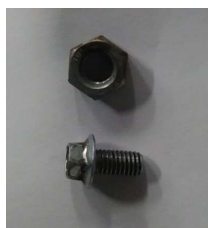
Rys. 4. Znaczniki radiograficzne użyte w eksperymentach.
