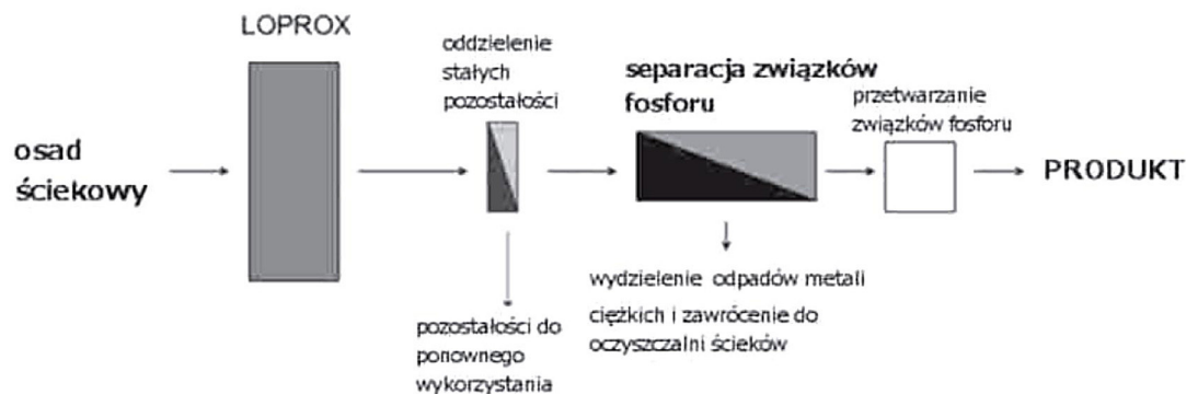
Rys. 4. Schemat procesu PHOXNAN [Blöcher i in. 2012, Poluszyńska i Słęczak 2015]
