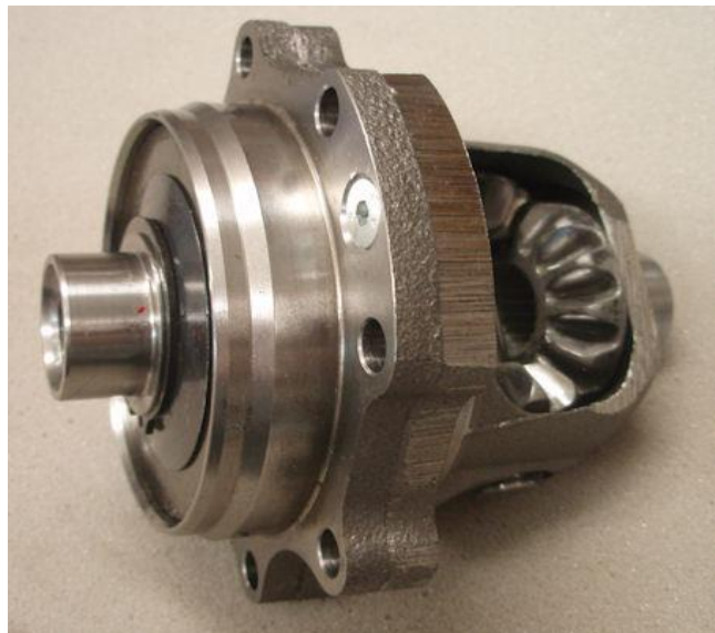
Rys. 1. Mechanizm różnicowy stożkowy powszechnie stosowany w pojazdach samochodowych
