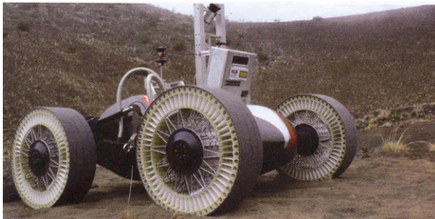
Rys. 3. Koła Tweel firmy Michelin zastosowane w najnowszej generacji pojazdu księżycowego Lunar Rover Vehicles [2].
