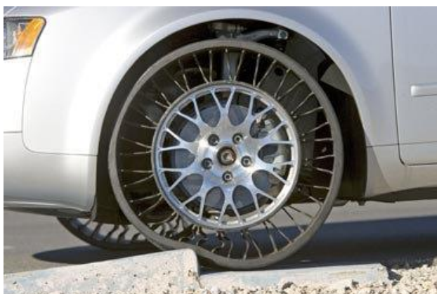
Rys. 11. Koła Tweel firmy Michelin zastosowane w samochodzie osobowym (prototyp) [7].
