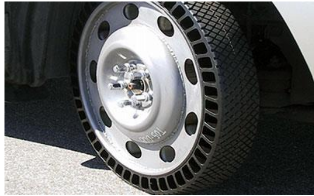
Rys. 16. Koło niepneumatyczne Amerityre firmy Amerityre [12].
