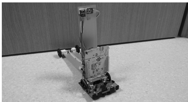
Rys. 6. Robot do automatycznego seryjnego pomiaru temperatury
