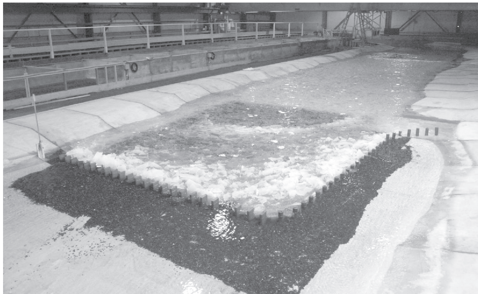
Ryc. 1. Model laboratoryjny filarowej przegrody lodowej projektowanej na rzece Grasse w stanie Nowy Jork; przy lewym brzegu widoczny jest kanał ulgi [Tuthill i in. 2008]
