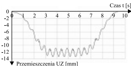
Rys. 8. Wynikowa funkcja przemieszczeń pionowych dolnego zamocowania krótkiej wanty dla przejazdu kolumny sześciu samochodów, z przeszkodą w środku przęsła Fig. 8. Final displacement function for vertical direction in short cable lower anchorage, under 6 trucks load, with threshold in the middle of span
