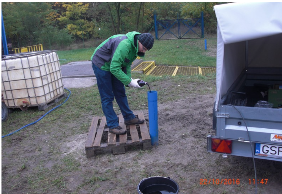
Rys. 6. Dawkowanie rodaminy WT do otworu badawczego.
