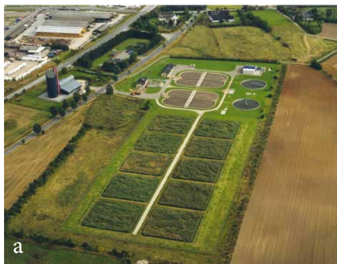
Rys. 8.2. Obiekty trzcinowe (STRB): a) rzut z góry na oczyszczalnię w Helsingørze (Dania), b) złoża trzcinowe w Gniewinie (Polska); źródła: Nielsen (2003), fotografia własna
