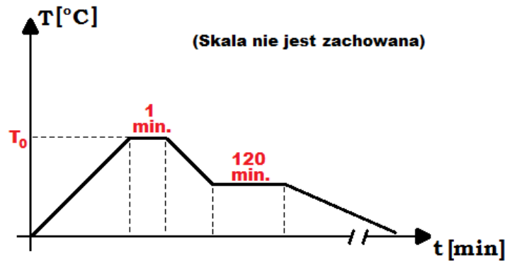
Rys. 2. Schemat grzania próbek materiału w piecu grzewczym.
