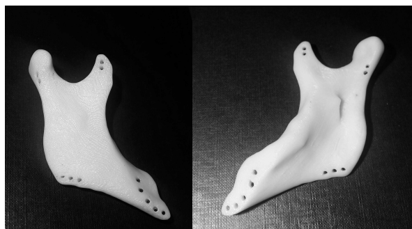
Rys. 8. Gotowy implant indywidualny wykonany technologią druku 3D
