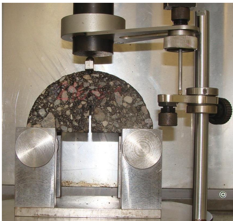
Fotografia 1. Próbką SCB przygotowana do badania odporności na pękanie Photo 1. SCB sample prepared to fracture test
