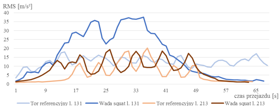
Rys. 7. Wyniki pomiarów z czujnika trójosiowego umiejscowionego na szyjście szyny kierunku Z dla odcinków torów referencyjnych oraz powierzchni z wadą squat
