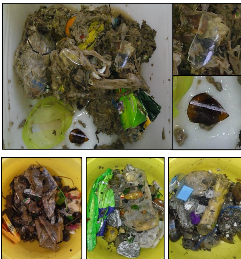
Rysunek 45. Frakcja organiczna odpadów komunalnych po ługowaniu (widoczne fragmenty szkła oraz inne odpady inertne)
