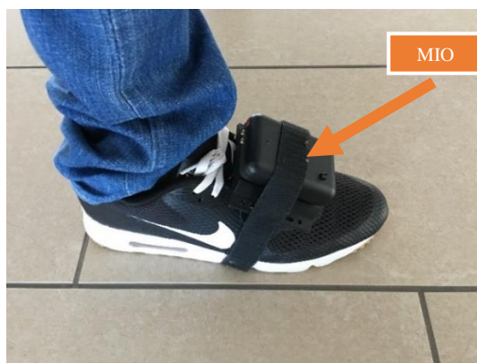
Rys. 6.2. Sposób umieszczenia modułu identyfikacji osobistej MIO na stopie monitorowanej osoby.
