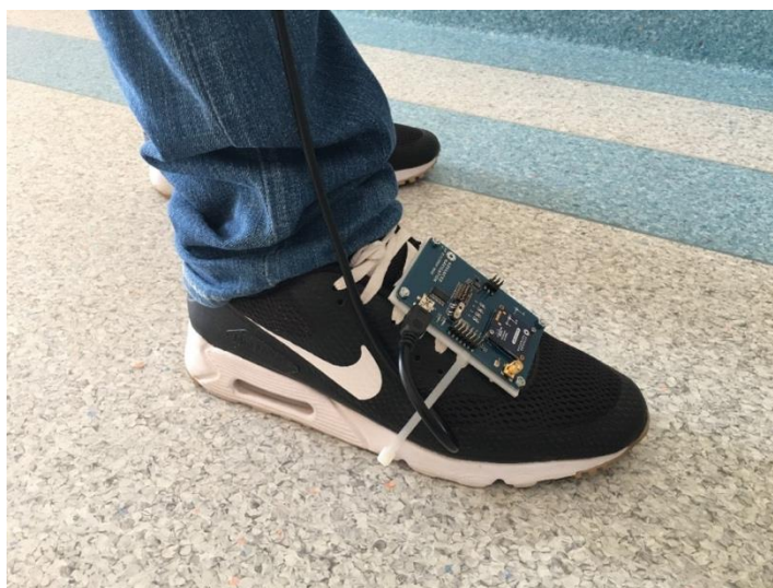
Rys. 4.1. Widok modułu inercyjnego umieszczonego na podbiciu stopy.
