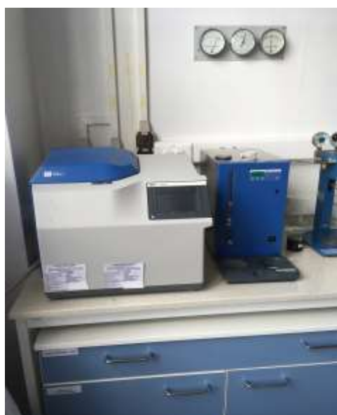
Rys. 2. Widok ogólny kalorymetru IKA C6000 na stanowisku laboratoryjnym przedsiębiorstwa LOTOS Asfalt Sp. z o.o (a), zbliżenie panelu sterowniczego (b)
