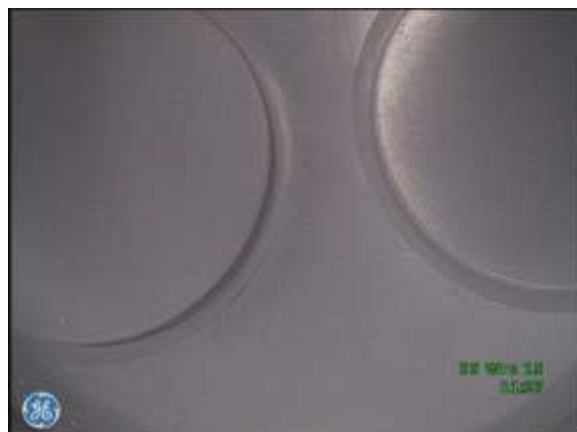
d) Dolna płyta głowicy z gniazdami zaworowymi
