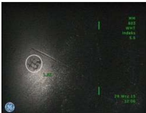
e) Przymiar kołowy oznaczenia wybitego na denku tłoka wykonany metodą „Cienia” - 1,96 mm z indeksem dokładności 5,5, co odpowiada błędowi bezwzględnemu rzędu 0,25 mm
