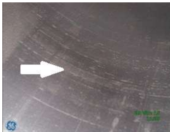
b) Gładz cylindrowa w rejonie DMP - ślady zużycia ściernego, brak śladów "honowania" tulei
