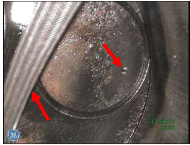
b) Dolna płyta głowicy, zawór wylotowy – widoczna sonda inspekcyjna wideoendoskopu, nieznaczne wgniecenie na powierzchni grzybka zaworowego
