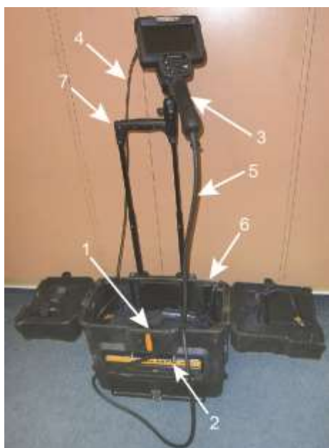
Rys. 2. Widok ogólny wideoendoskopu pomiarowego Everest typu XLG3 przygotowanego do użytkowania: 1 – jednostka centralna; 2 – panel sterowniczy; 3 – rękojeść videosondy; 4 – sonda inspekcyjna; 5 – światłowód iluminacji obiektu; 6 – walizka; 7 – rączka transportowa (montażowa)
