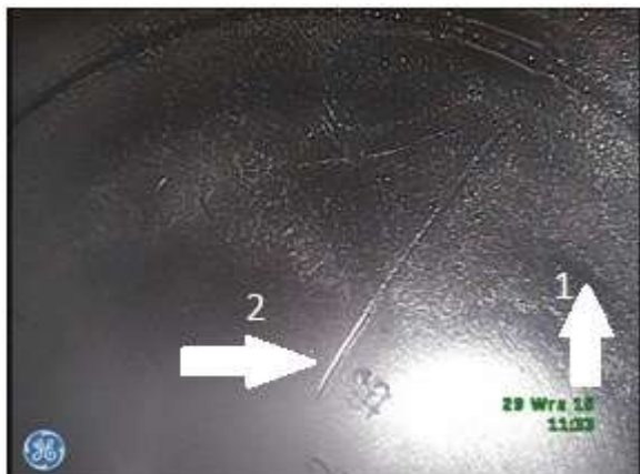
c) Denko tłoka - widoczne ślady nagaru (1) oraz zarysowanie powierzchni (2)
