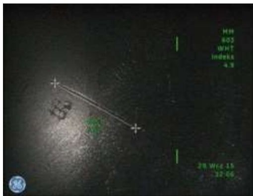
c) Pomiar długości rysy na denku tłoka wykonany metodą „Cienia” - 7,52 mm z indeksem dokładności 4.9, co odpowiada błędowi bezwzględnemu rzędu 0,3 mm
