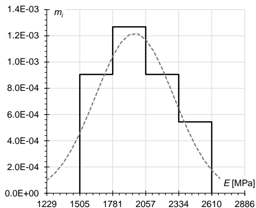
Rysunek Z.70 Zestawienie histogramu modułu sprężystości próbek płyty MgO z panelu nr 1 poddanych jednoosiowemu ścisnaniu w kierunku podłużnym (linia ciągła) z krzywą rozkładu normalnego Gaussa dla \bar{x} = 1964 MPa i s_x = 327 MPa (linia przerywana)
