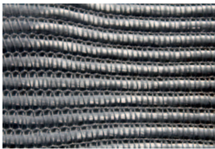
Fot. 8. Przędzina deklarowana jako geotkanina (awers i rewers)
