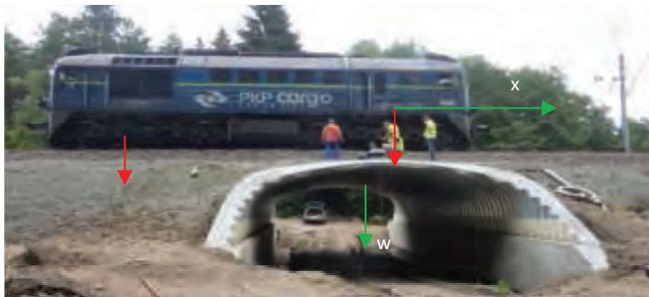
7. Położenie lokomotywy w trakcie obciążenia
