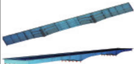
Rys. 5. Model numeryczny MES w środowisku MES SOFiSTiK [10]
