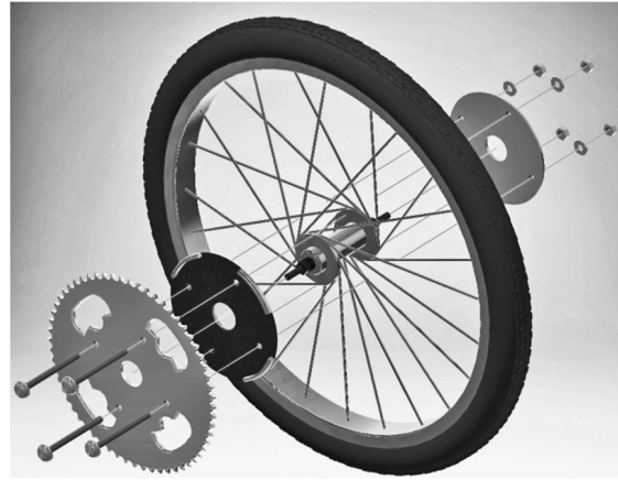
Rys. 6. Mocowanie zębatki wyjściowej Fig. 6. Fastening the starting rack
