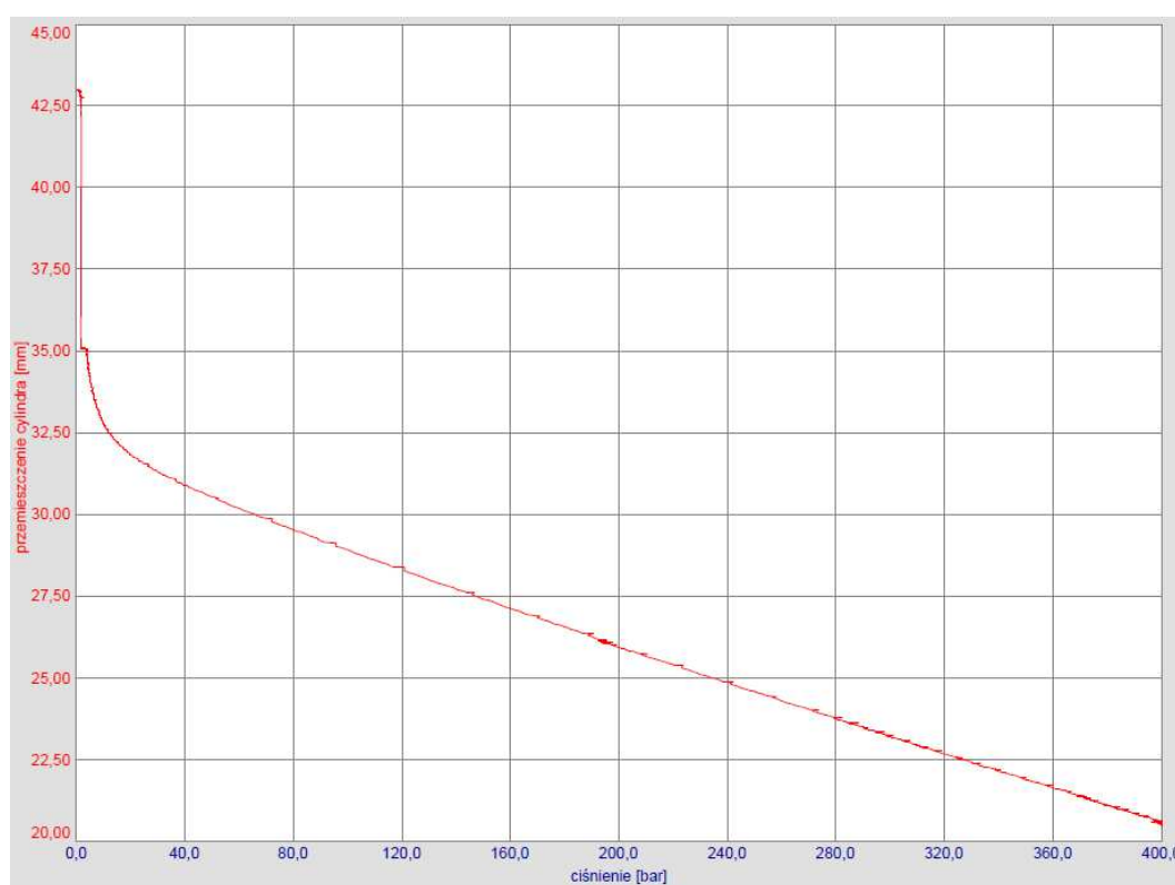
Rys. 6.9 Wynik pomiaru przemieszczenia cylindra pomiarowego w przyrządzie, dla oleju mineralnego VG46 o zawartości X_0=2\% nierozpuszczonego powietrza w próbce dla temperatury 25°C (wydruk z przyrządu HMG3000 firmy Hydac)
