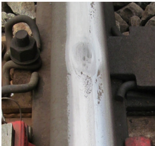
Rys. 2 - Wada SQUAT Źródło: opracowanie własne
