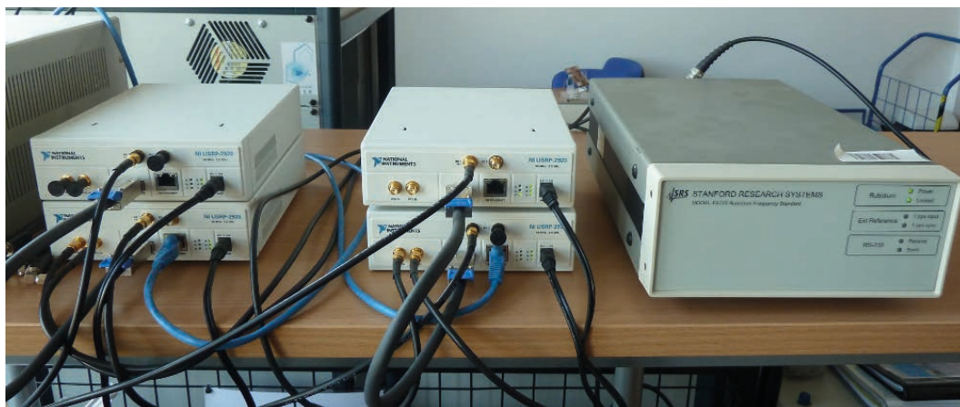
Rys. 4. Moduły radia programowalnego oraz rubidowy wzorzec częstotliwości
