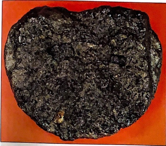
Abb. 5: Kohliger Schluff mit Krantzitkörnern auf einer Schichtfläche in der Bohrung Prä 3/2013 (Foto: R. Wimmer).
