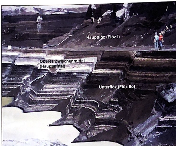
Abb. 7: Oberes Zwischenmittel, ein grauer sandig-toniger, kohlig-er Schluff zwischen dem mitteleozänen Unterflöz (Flöz II) und dem obereozänen Hauptflöz (Flöz I) (Foto: R. Wimmer).
