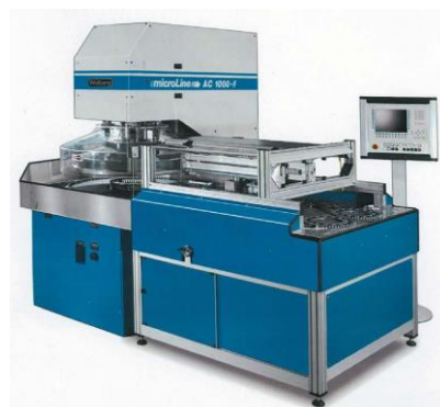
Rys. 1. Widok ogólny docierarki AC1000-F firmy Peter Wolters do szlifowania dwustronnego z kinematyką docierania, mogącej realizować różne strategie obróbkowe [5]
