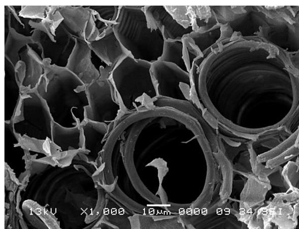
Rys. 1. SEM. Widok ogólny struktury przekroju a) podłużnego b) poprzecznego paździerzki konopnych [Nguyen et al. 2010]
