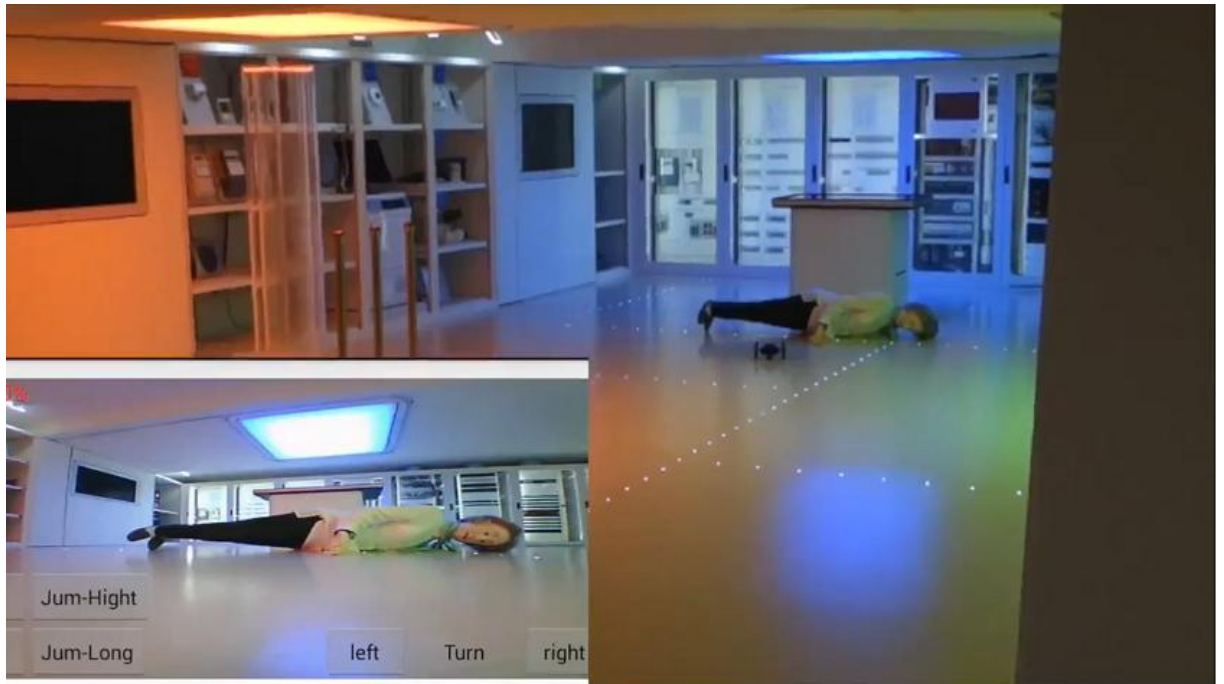
Rys. 5.5. Zdalny monitoring zdarzeń w pomieszczeniach jako praktyczny przykład sterowania dronem za pomocą czujnika gestów umieszczonego w okularach multimedialnych. Dolna część rysunku zawiera podgląd obrazu widzianego z drona, który może być transmitowany do okularów.
