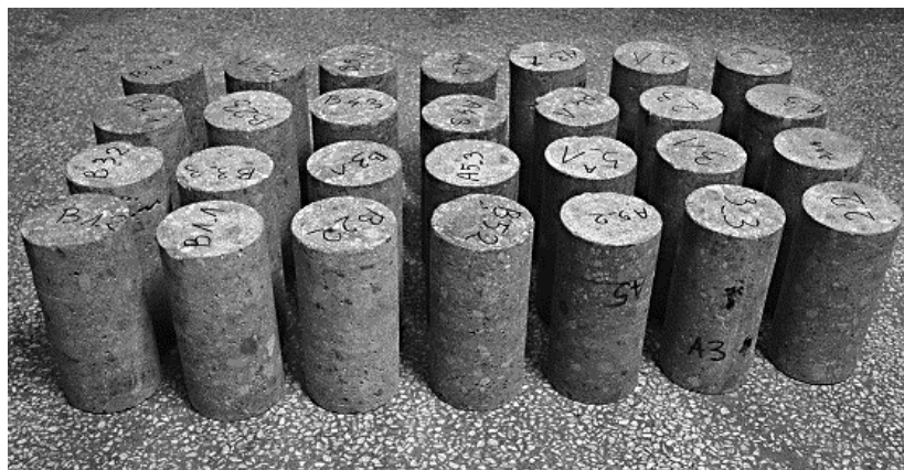
Rys. 3. Walcowe próbki betonu
