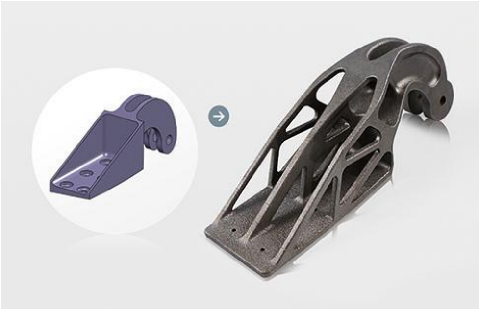
Projekt konwencjonalnego wspornika odlewanej ze stali (z lewej) oraz (z prawej) wspornika tytanowego ze zoptymalizowaną topologią wykonanego w technologii DMLS (źródło: EADS)
