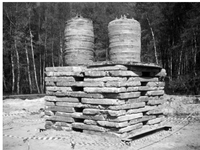
Rys. 6. Obciążenie kolumn z kruszywa
