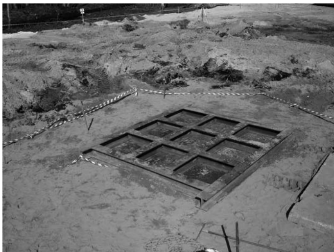
Rys. 5. Podstawa konstrukcji obciążającej kolumnę z kruszywa
