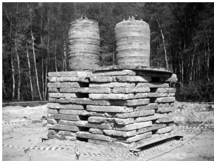
Rys. 6. Obciążenie kolumn z kruszywa.
