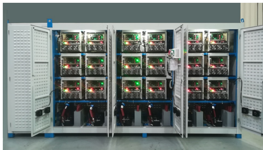
Rys. 1. Trójfazowy e-transformator MMB Drives o mocy 1 MW na napięciu 4kV wykonany w technologii SiC MOSFET z 18 celek AC-DC-AC-transformator-AC-DC-AC, z przeznaczeniem do napędów przemysłowych.
