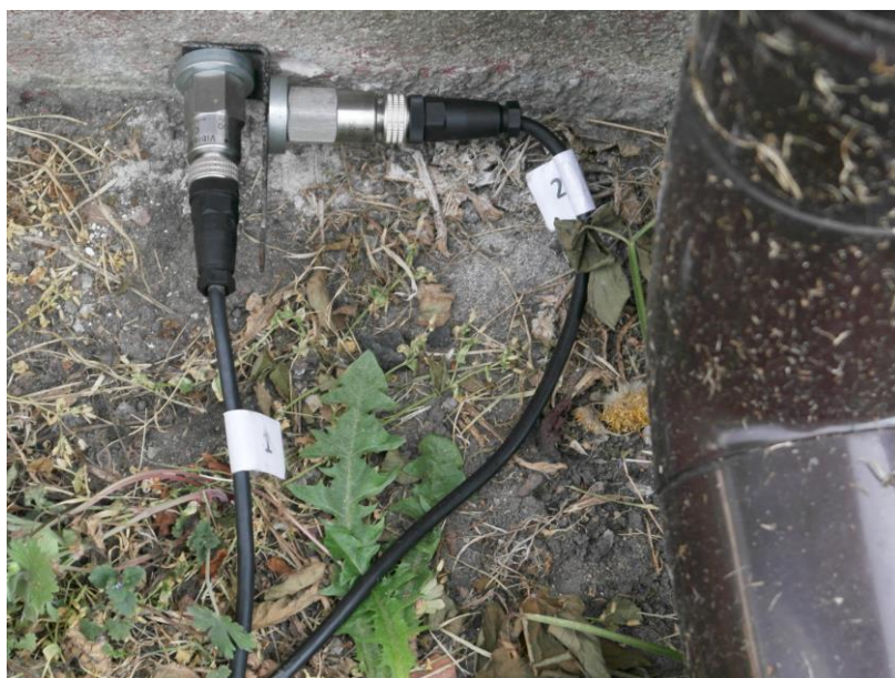
Rys. 3.3. Sposób montażu czujników piezoelektrycznych do budynku.
