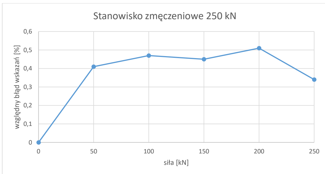
Rys. 10.3 Krzywa średniego błędu wskazań dla pomiaru siły na stanowisku badawczym
