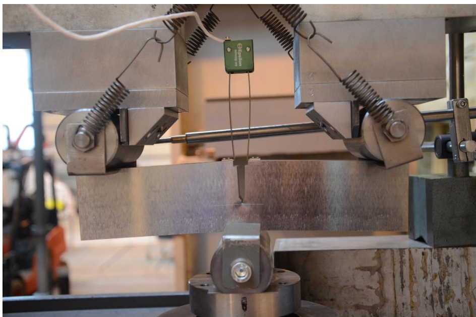
Rys. 10.11 Próbkę nr 5 z serii B30 ( a_0/W = 0,62 ) w trakcie próby
