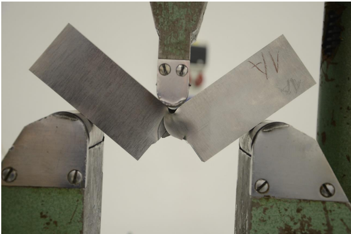
Rys. 10.13 Próbka z serii B30 w trakcie dołamywania
