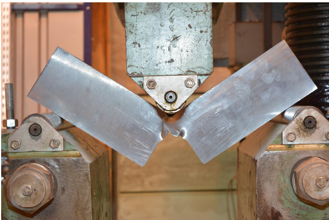
Rys. 10.14 Próbkę z serii B60 w trakcie dołamywania
