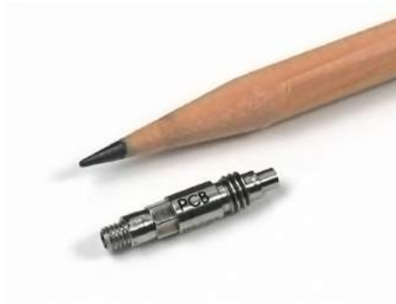
Rys. 7.8. Piezoelektryczny czujnik ciśnienia - odniesienie wielkości czujnika do wielkości ołówka
