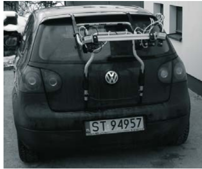
Fot. 3. Sposób montażu systemu stereowizyjnego [7]
