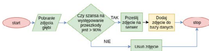
Rys. 4. Przepływ zdjęć głębi przez system: na zielono – elementy znajdujące się w aplikacji klienckiej, na żółto – elementy aplikacji serwerowej
