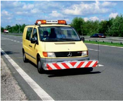
Fot. 2. Wykorzystywany przez GDDKiA profilograf laserowy [6]
