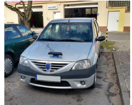
Fot. 4. Samochód z zamontowanym sensorem Kinect. Źródło: opracowanie własne
