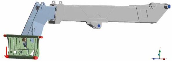
Rys. 11. Sposób obciążenia i podparcia wysięgnika: kolor czerwony – miejsce przyłożenia siły; kolor niebieski – podparcie
