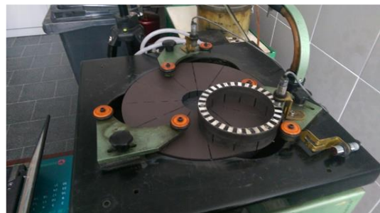
Rys.3. Widok układu wykonawczego docierarki jednotarczowej ABRALAP 380 (założony jeden pierścień prowadzący)
