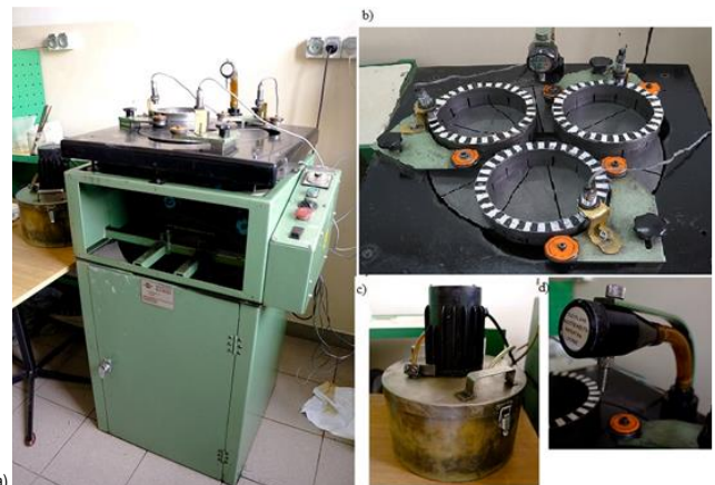
Rys.2. Widok ogólny: a) docierarki jednotarczowej; b) pierścieniowego układu wykonawczego; c) zbiornika z zawieszoną ścierną i pompą; d) wylotu układu dawkującego zawieszinę na tarczę docierającą
