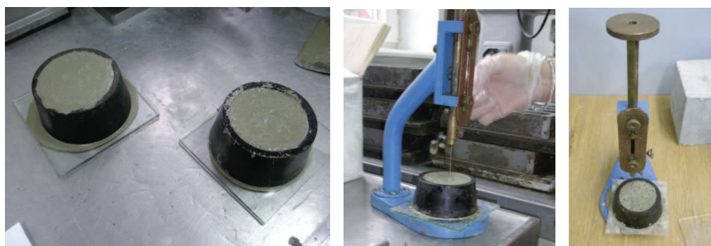
Rys. 4.7. Pomiar czasu wiązania
