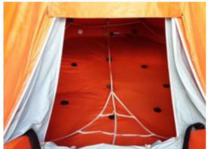
Rys. 6. Podłoga tratwy z otworami odprowadzającymi wodę [6]
