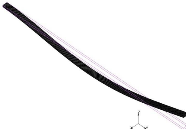
Rys. 4.252 Druga postać poprzeczna drgań własnych pojedynczej aluminiowej belki wspornikowej.
