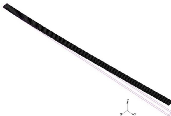
Rys. 4.251 Pierwsza postać poprzeczna drgań własnych pojedynczej aluminiowej belki wspornikowej.
