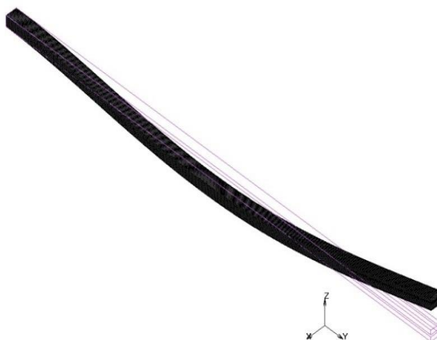
Rys. 4.254 Druga postać poprzeczna drgań własnych złożonej belki wspornikowej z warstwą polimeru.
