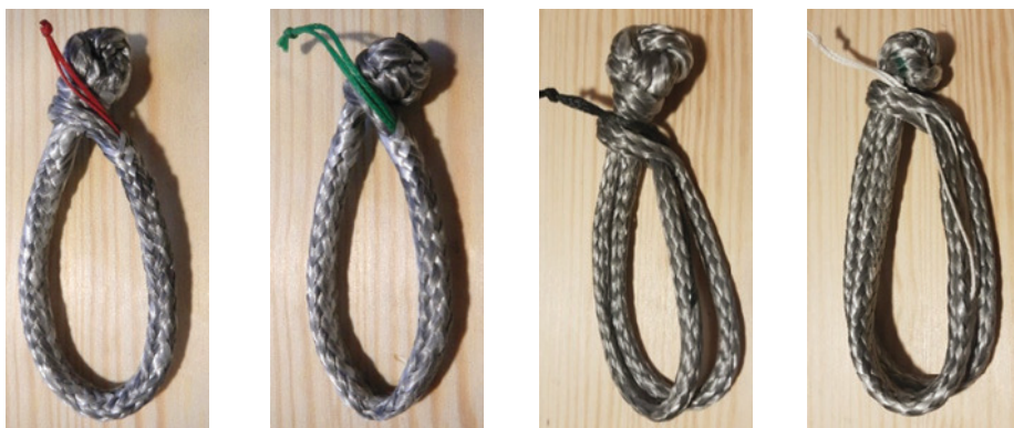
Rys. 16. Miękkie szekle (od lewej): z węzłem półprzeplecionym, z węzłem diamentowym, z węzłem oversize i węzłem guzikowym
